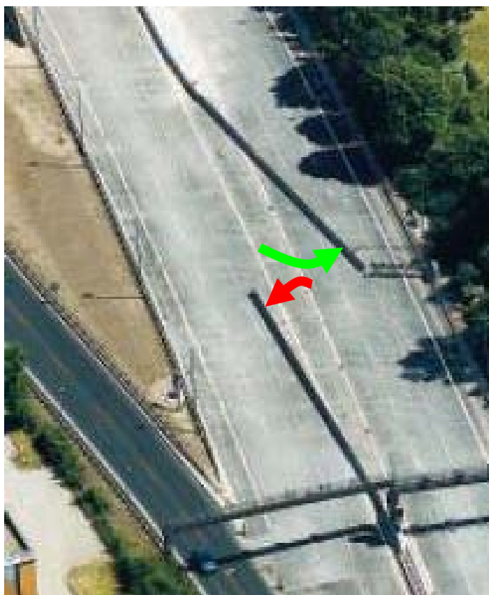
Slika 44: Samodejni stranski premik jeklene varnostne ograje [4]
