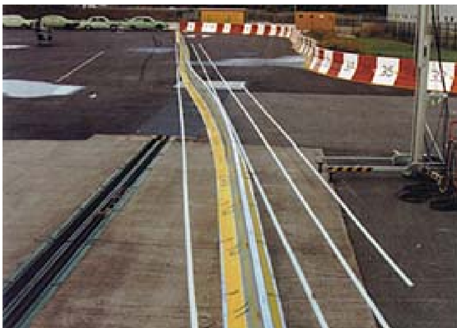
Slika 14: Majhen pomik ograje pri naletu vozila [1]
