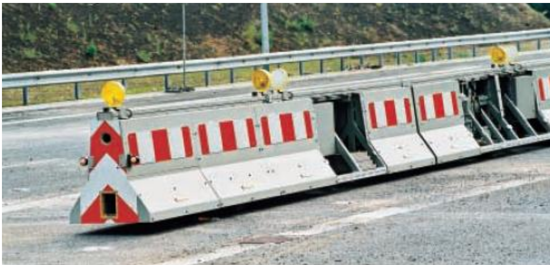
Slika 42: Jeklene PVO narejene po sistemu New Jersey [4]
