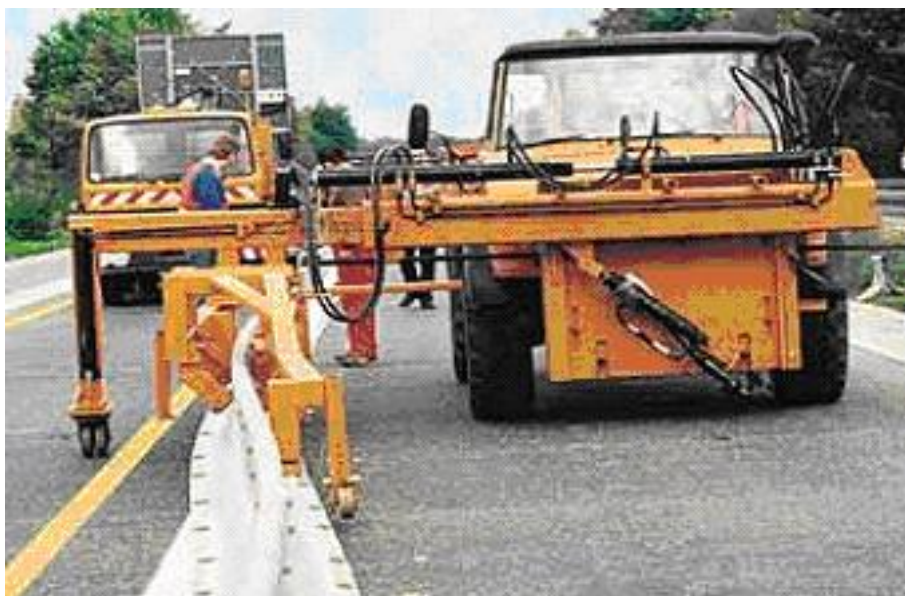
Slika 21: Transportno vozilo pri premikanju ograje [1]
