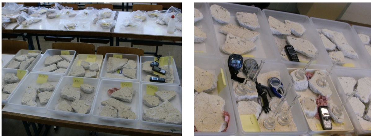
Slika 38: Meritve vodovpojnosti fasadnega ometa (grobi + fini + oplešk)
