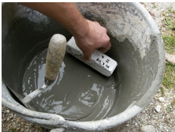
Slika 33: Izdelava izravnave prizmic fine malte s cementno pasto za tlačni preizkus
