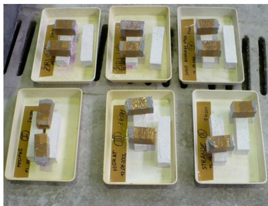
Slika 22: Pripravljene prizmice grobih malt za meritve vodovpojnosti in tlačne trdnosti
