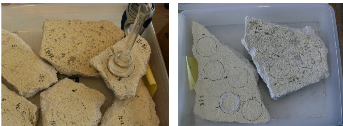
Slika 39: Prikaz površine vzorcev fasadnega ometa po meritvi vodovpojnosti
