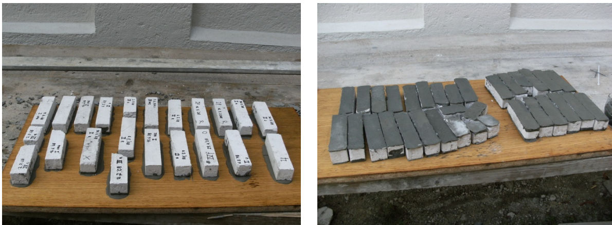
Slika 34: S cementno pasto izravnane prizme finih malt
