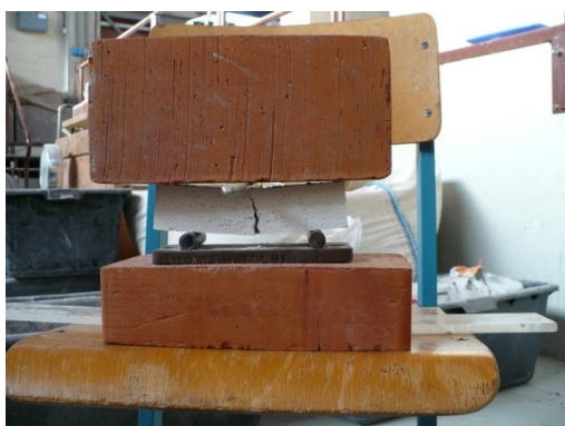
Slika 23: Razpolavljanje prizmic vzorcev grobih malt in meritev vodovpojnosti
