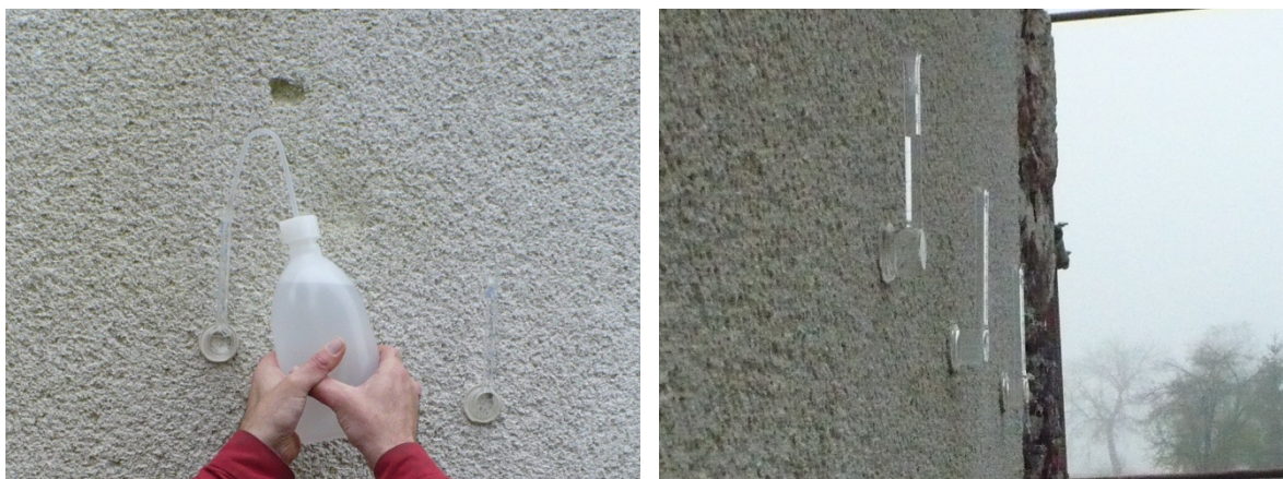
Slika 18: Meritve vodovpojnosti na vzorcih grobih ometov
