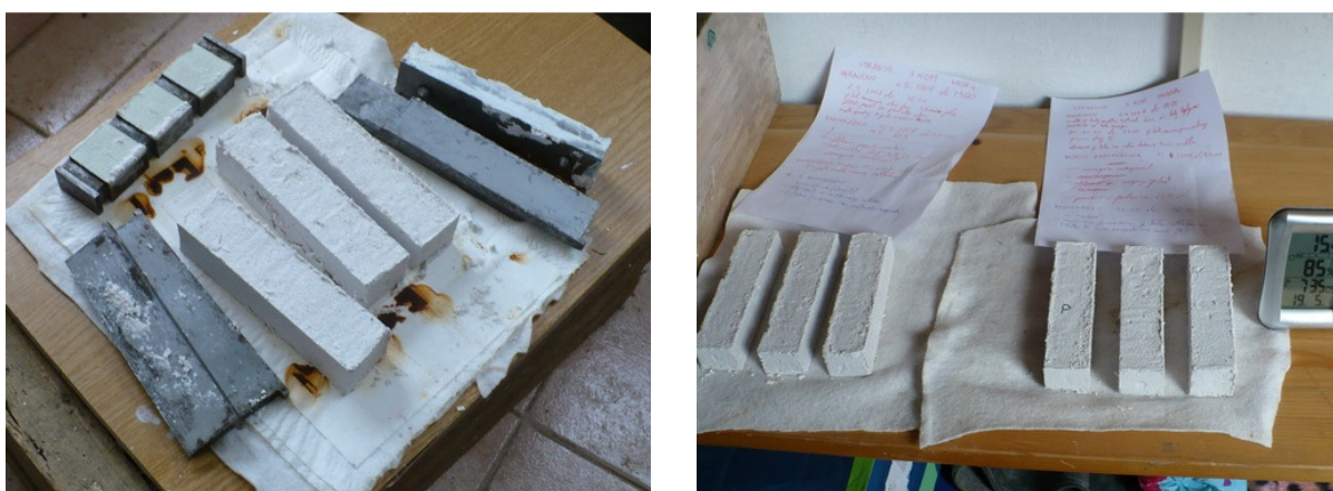
Slika 32: Prizmice tik po razopaženju in strjevanje
