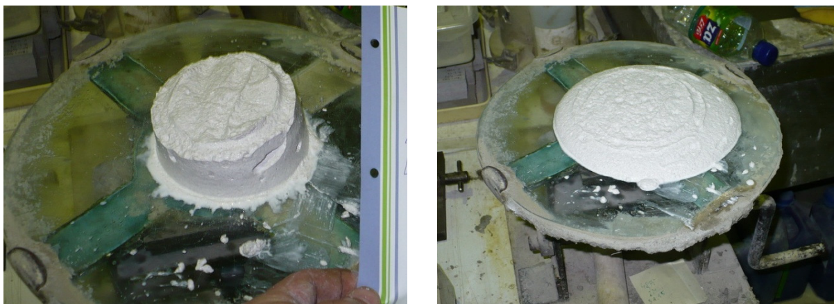
Slika 28: Razlez fine malte po 15 padcih na stresalni mizici (vzorec IIf )
