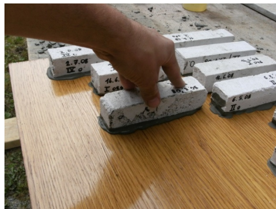
Slika 33: Izdelava izravnave prizmic fine malte s cementno pasto za tlačni preizkus
