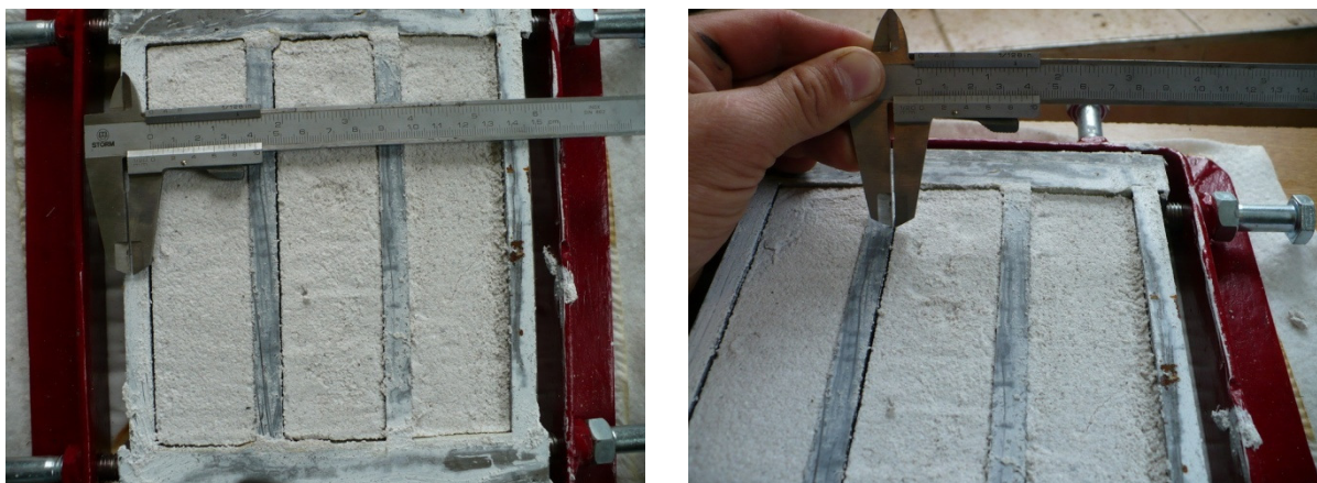
Slika 31: Prikaz skrčka fine malte po 5 dneh zaradi izgube vode
