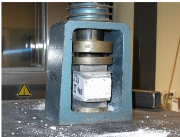
Slika 35: Tlačni preizkus prizmice vzorca fine malte
