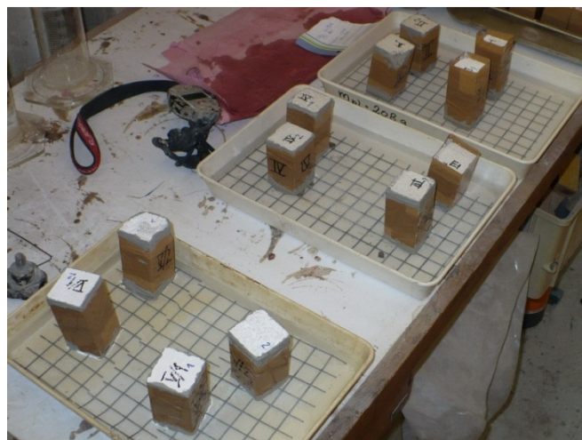
Slika 23: Razpolavljanje prizmic vzorcev grobih malt in meritev vodovpojnosti
