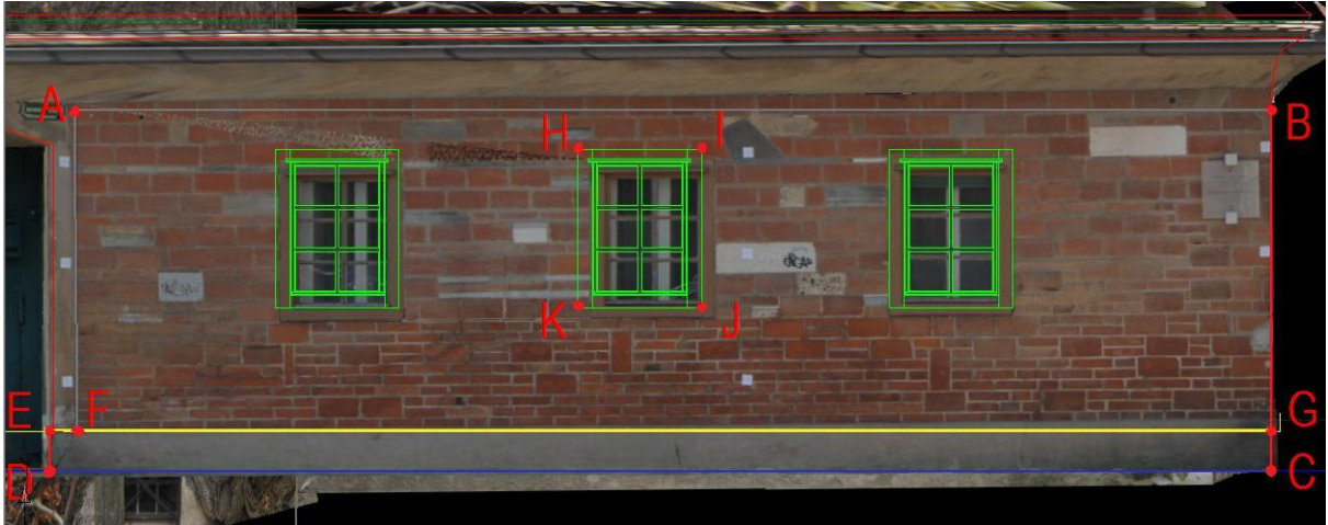
Slika 41: Združena ortofoto in vektorski načrt vzhodne fasade (Karunova 4 – desni del).
