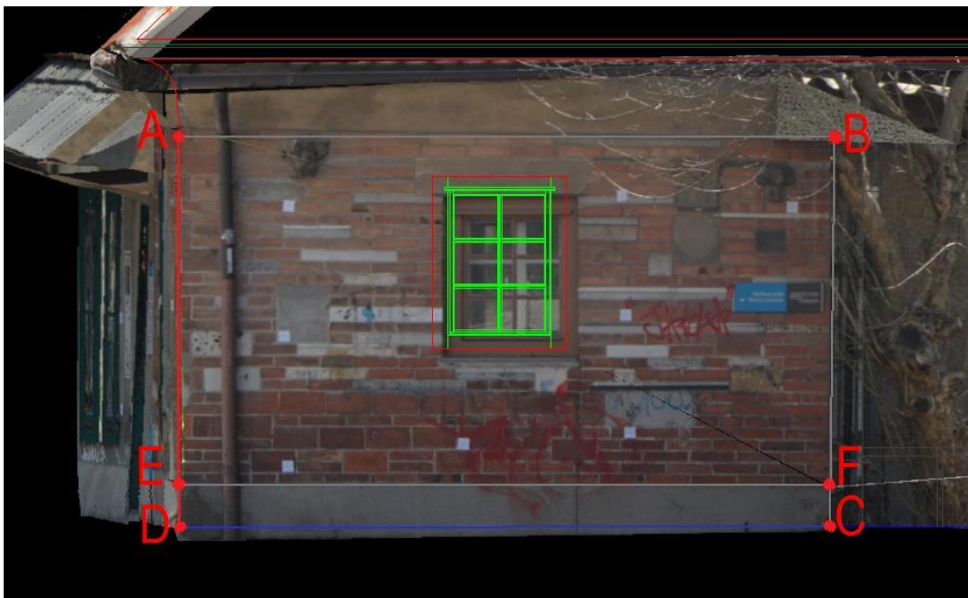
Slika 42: Združena ortofoto in vektorski načrt severne fasade (skrajni levi del severne fasade na Karunovi 4).
