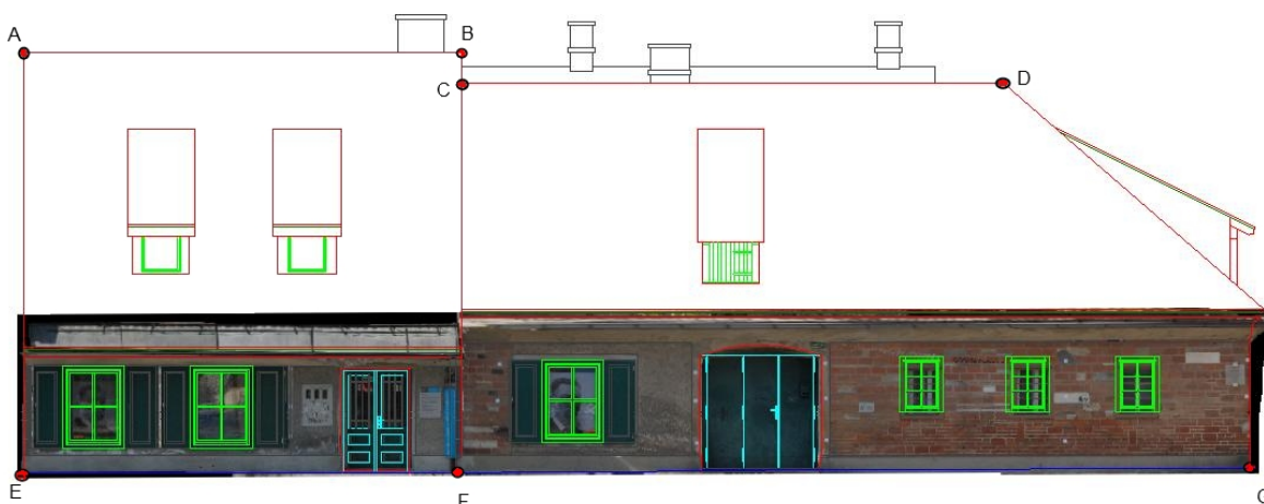
Slika 39: Primerjava dolžin objekta na V fasadi (ortofoto in arhitekturni posnetek stanja).
