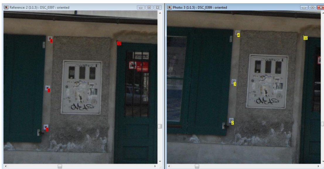
Slika 16: Določitev oslonilnih točk v programu PhotoModeler.
