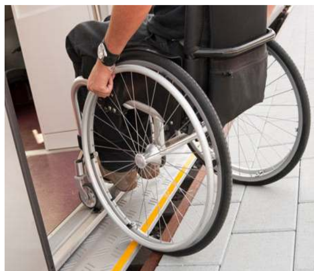
Slika 44: Primer avtomatskega premoščanja odprtin
