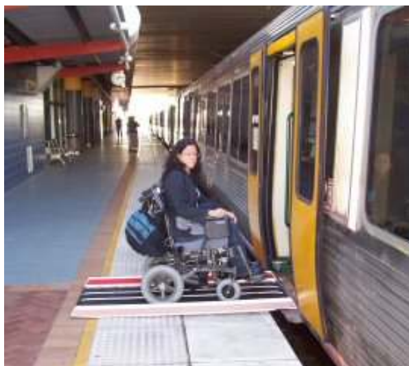
Slika 45: Primer montažnega premoščanja odprtin
