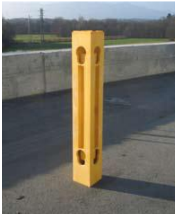
Začetek montaže vedno z vogalnikom, ki je pravilno obrnjen, in sicer razširjen del luknje mora biti na vrhu.
