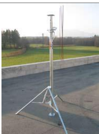
Pritrditev podpornikov na tronožce.
