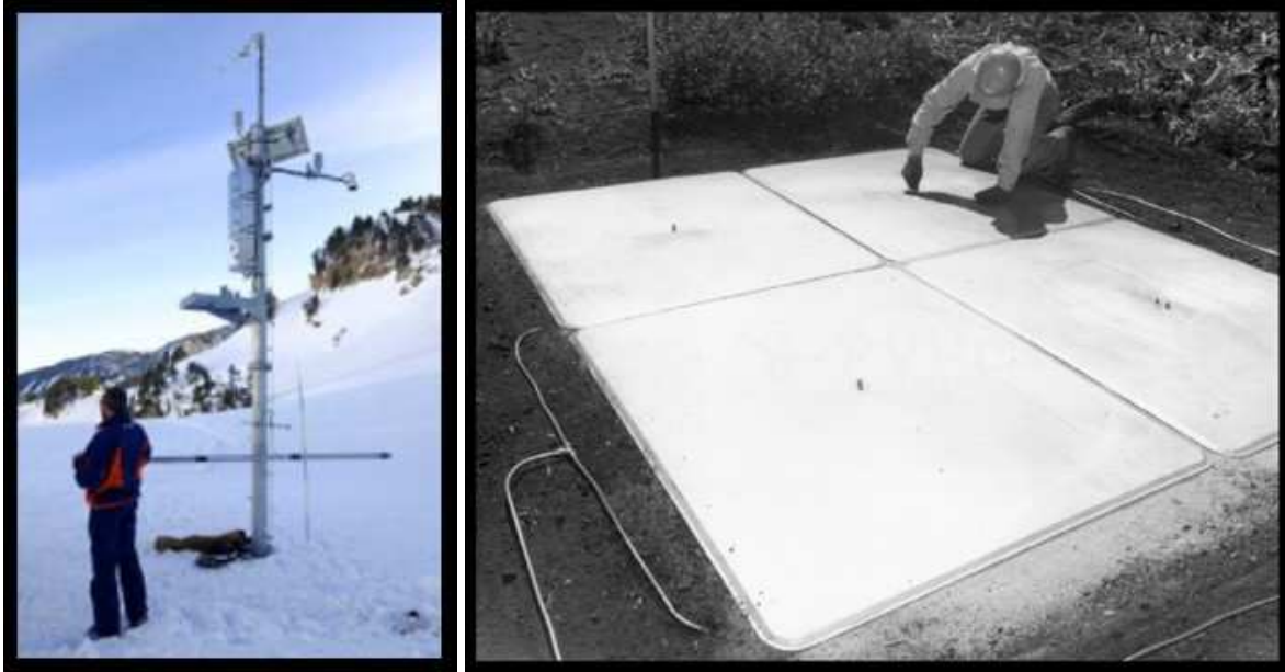
Merilec kozmične radiacije s pripadajočo opremo (NRC). Polaganje snežnih blazin ( www.cdec.water.ca.gov ).
