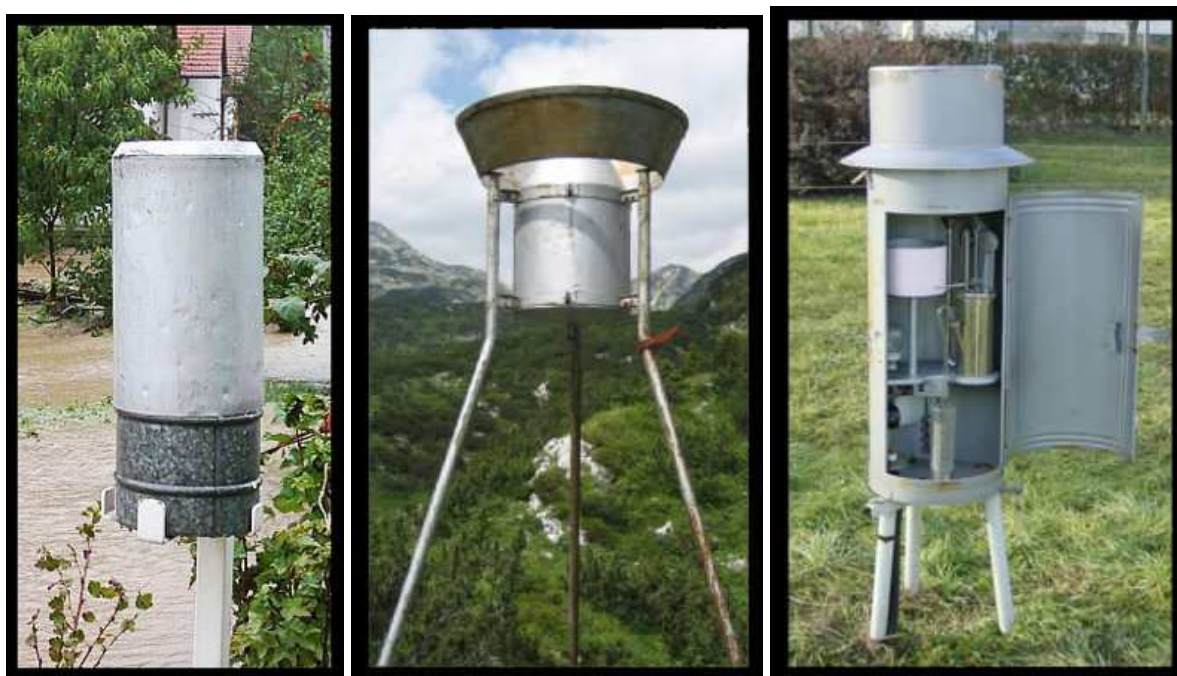
Ombrometer (Vičar Z.), Slika 3 : Totalizator, Komna., Ombrograf (ARSO).
