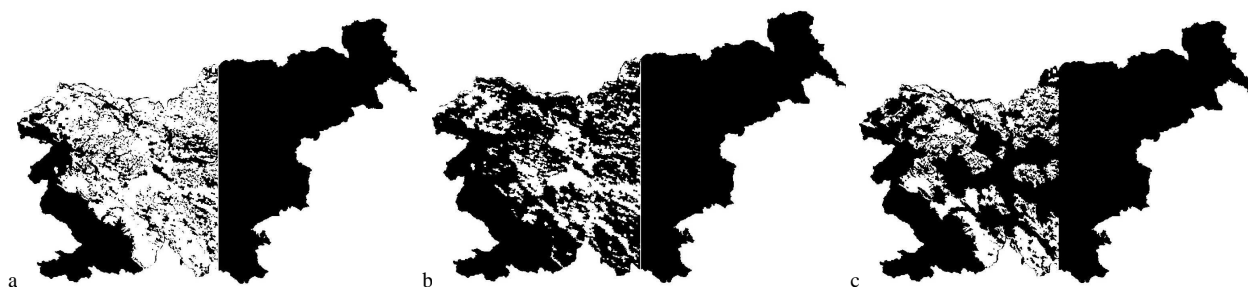
Slika 13: Prikaz obdelave posnetkov, a ) območja snega glede na podatke s postaj, b) območja satelitsko zaznanega snega, c) razlika snežnih površin obeh posnetkov.
