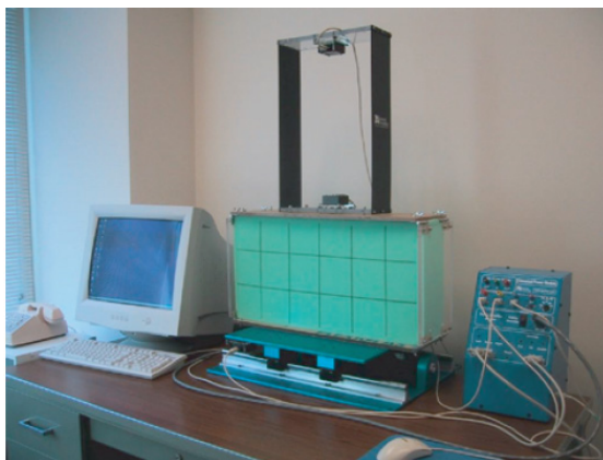
Slika 30: Sestavljen model iz zemljine in konstrukcije
