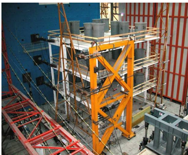
Slika 2: Trietažna nesimetrična stavba pripravljena za simulacijo potresne obtežbe z reakcijsko steno v laboratoriju ELSA (Joint Research Centre)
