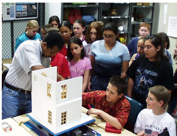
Slika 37: Prerezan model hiše s pohištvom postavljen na šolsko potresno mizo
