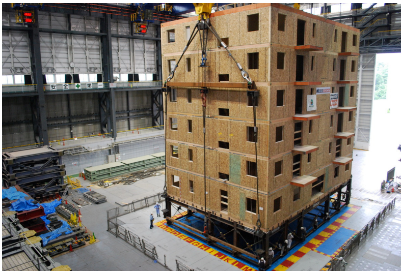
Slika 1: Priprava šest etažne lesene stavbe za eksperiment na potresni mizi E-Defense (Standing Strong: 2009 NEESWood Capstone Test)
