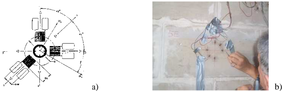
Slika 6: a) Shema razporeditve merilnih lističev okoli izvrtane luknje, b) prikaz meritve (Deliverable D11.3, 2004)
