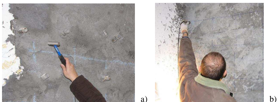
Slika 36: Meritev s kladivom; a) ustvarjanje impulzov z instrumentalnim kladivcem in b) registriranje signala s sprejemnikom
