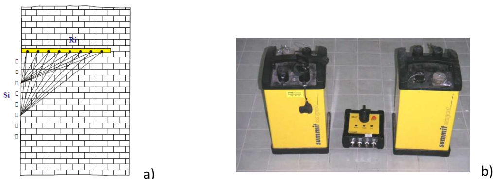
Slika 18: a) Postavitev oddajnikov (Si) in sprejemnikov (Ri) na preiskovani zid pri TSS profiliranju (Marchisio in sod., 2003), b) prikaz preiskave (Deliverable D11.3, 2004)
