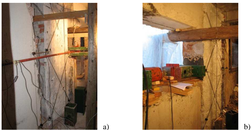
Slika 40: In-situ strižna preiskava zidu 1, b) vnašanje sile s hidravličnim batom na zid 4
