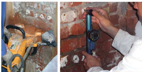
Slika 3: Priprava utora in preiskava z enojno jekleno blazino (Deliverable D11.3, 2004)
