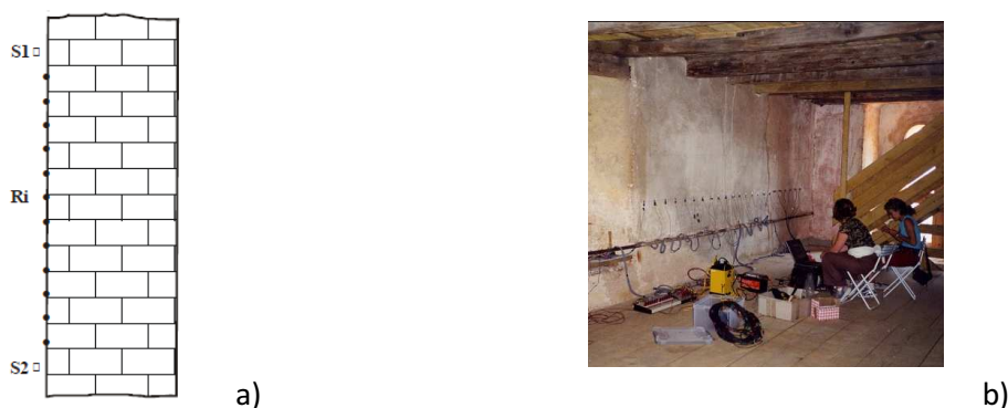
Slika 16: a) Shematičen prikaz postavitve oddajnikov (S1 in S2) in sprejemnikov (Ri) na preiskovani zid pri mikro-seizmičnem profiliranju (Marchisio in sod., 2003), b) prikaz preiskave (Deliverable D11.3, 2004)
