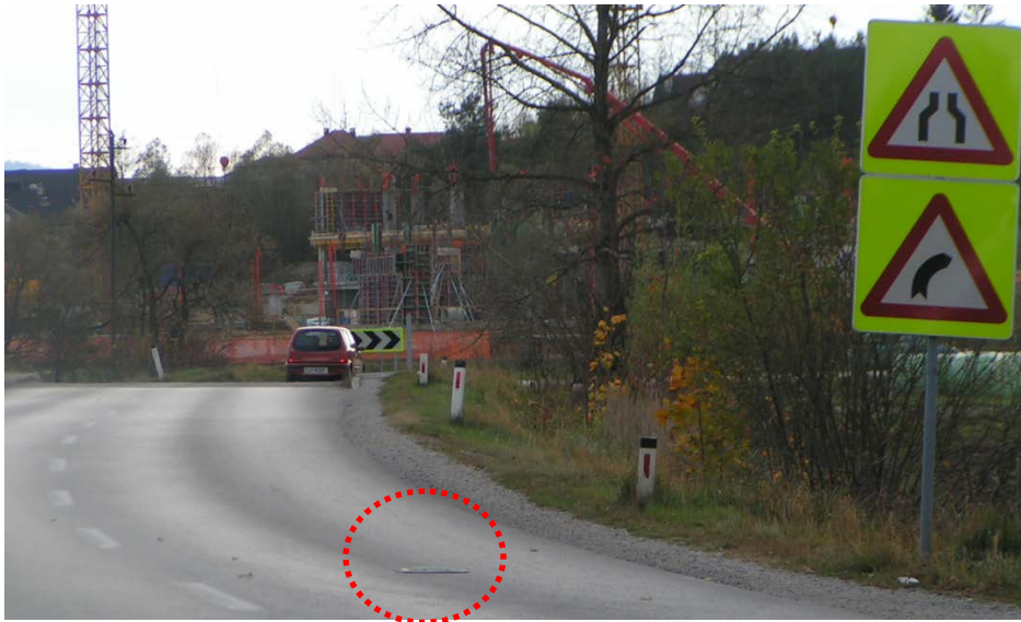
Slika 22 : Primer postavitve NU-metrics števec na Brdnikovi cesti
