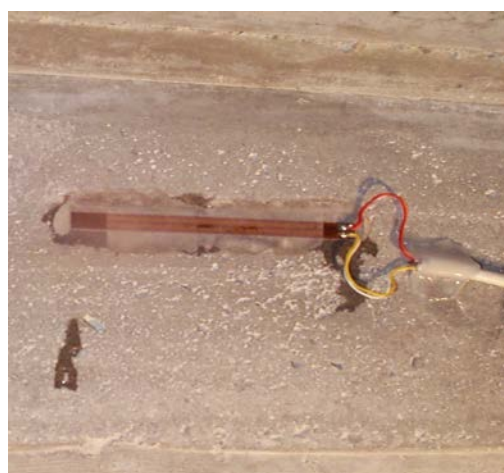
Slika 36: Merilni listič, pritrjen v notranjosti merjenega objekta
