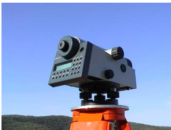
Slika 29 : Digitalni nivelir Zeiss DiNi 21
