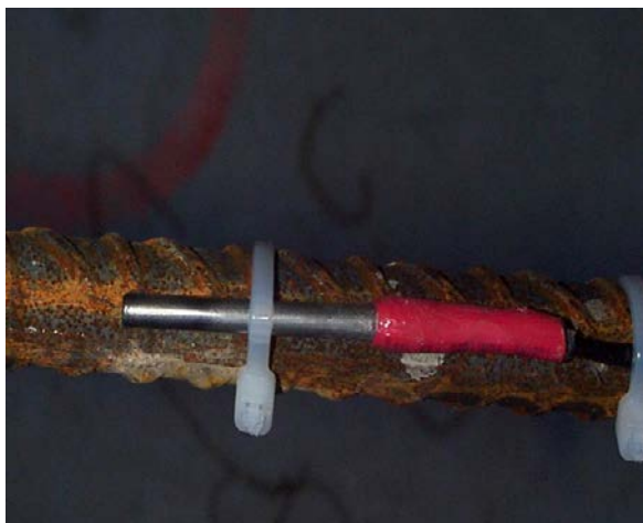
Slika 5 : Tipalo za merjenje temperature v betonu
