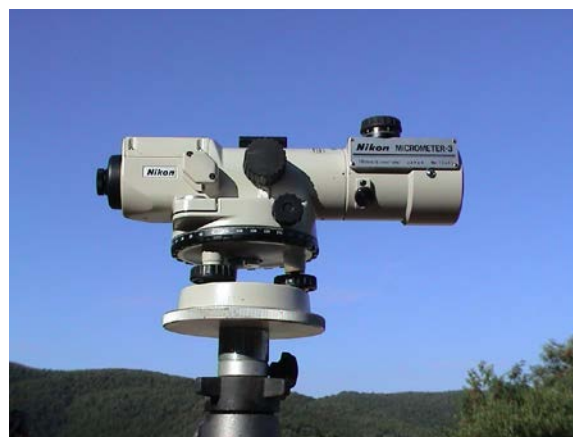
Slika 30: Nivelir NIKON AE 7C z dodatnim mikrometrom
