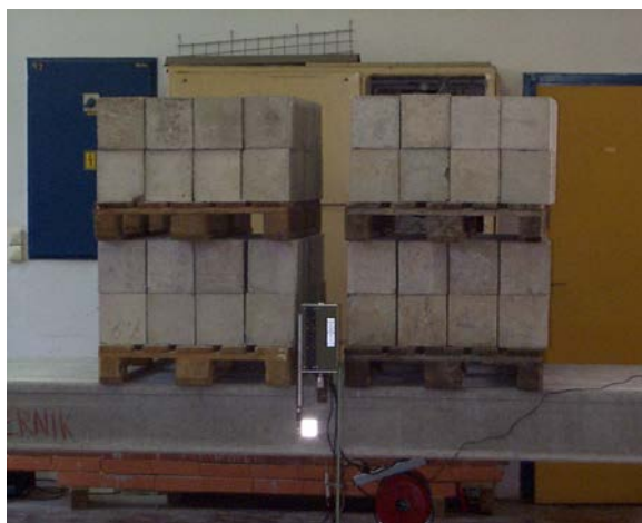
Slika 8: Prednapeta votla plošča tipa PVP 5 pod obremenitvijo
