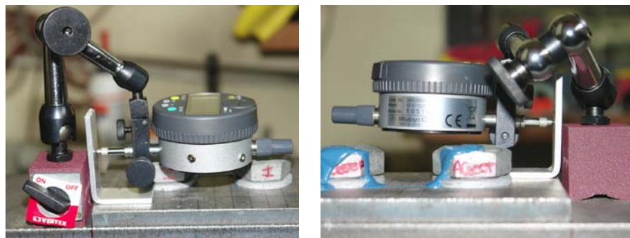
Slika 6.28: Pritrditev merilne urice na stojalo
