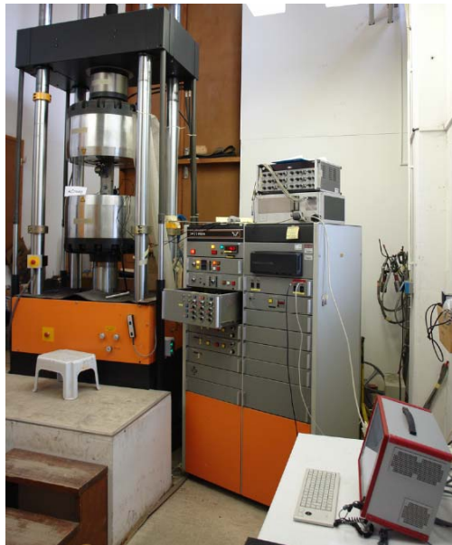
Slika 6.4: Z leve proti desni: Instron, konzola za upravljanje, Dewetron
