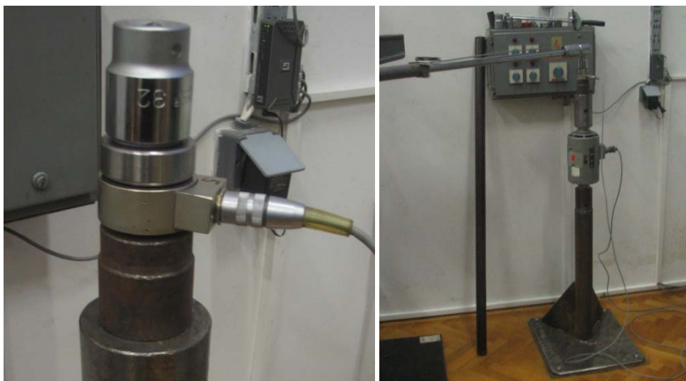
Slika 4.1: Merilna naprava za določanje momenta prednapetja vijakov
