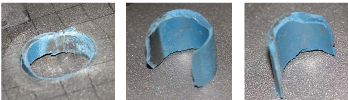
Slika 6.53: Deformacije injekcijske mase
