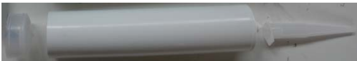
Slika 3.5: Plastični cilinder z batom na levi in lijakom na desni strani
