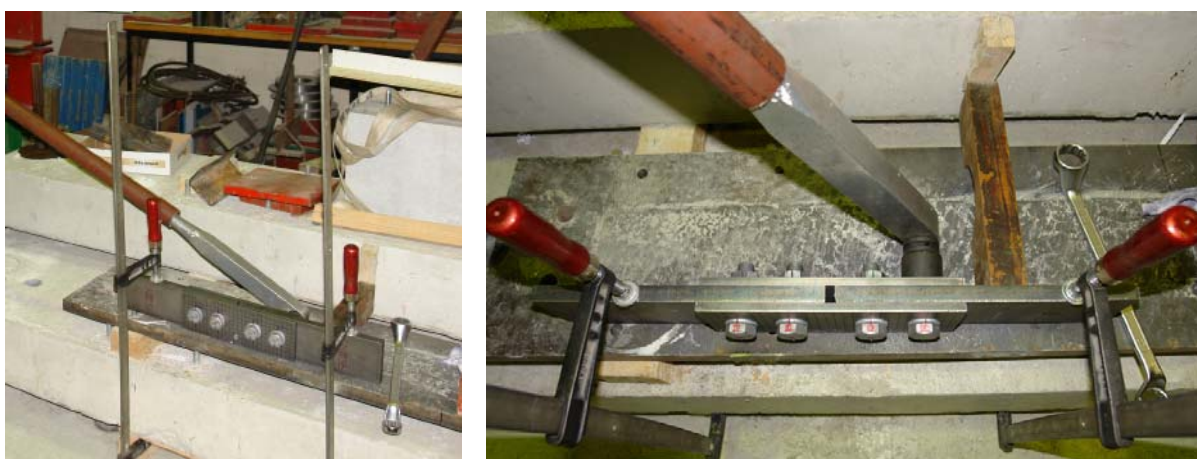
Slika 4.2: Fiksiranje preizkušanca in prednapenjanje vijakov
