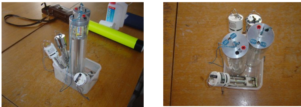
Slika 7: Komparacija termometrov, psihrometrov.
