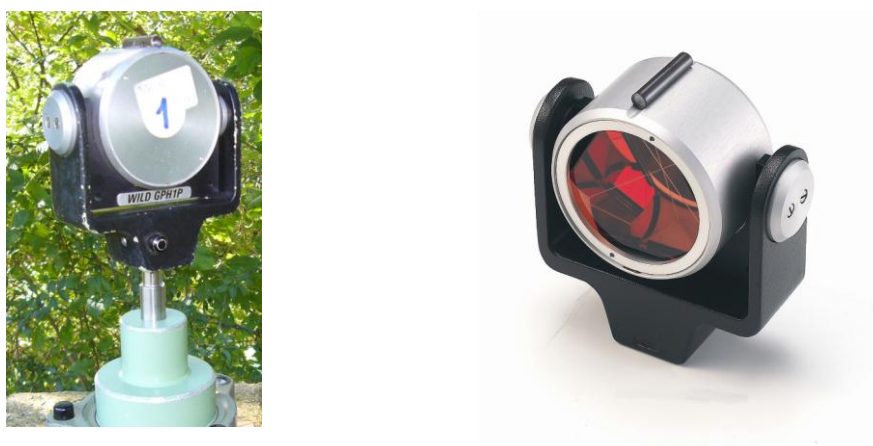
Slika 3: Precizna prizma GPH1P.
