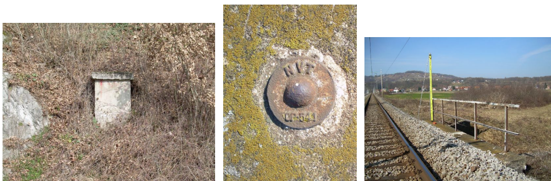
Slika 18: Fundamentalni reper FR 1018 (levo) in reper OP 541 (na sredini, desno)
