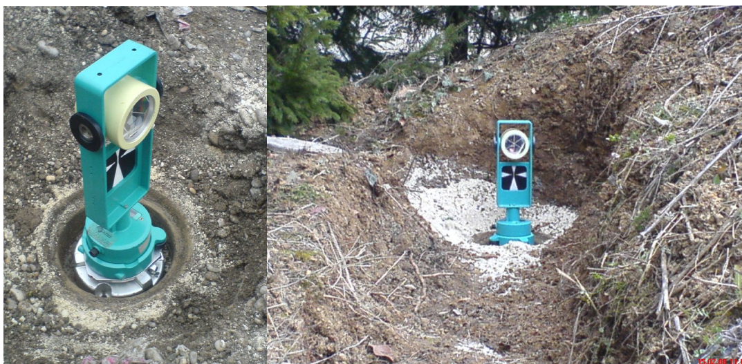
Slika14: Prisilno centriranje na točki A (levo) in na točki D (desno)
