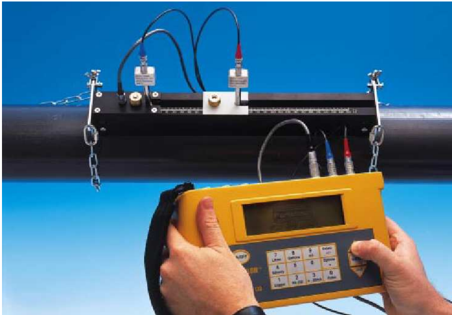
Slika 23: Prenosni ultrazvočni merilnik pretoka s senzorji in prižemko (Measurment Resources Pty Ltd., 2003)
