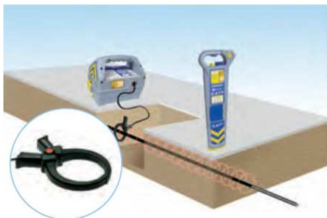
Slika 11: Induktivni način iskanja z induktivnimi kleščami (Radiodetection Ltd, 2005)
