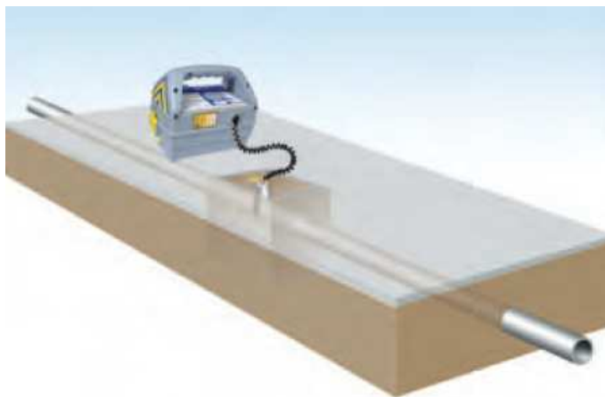
Slika 12: Galvanski način iskanja (Radiodetection Ltd, 2005)
