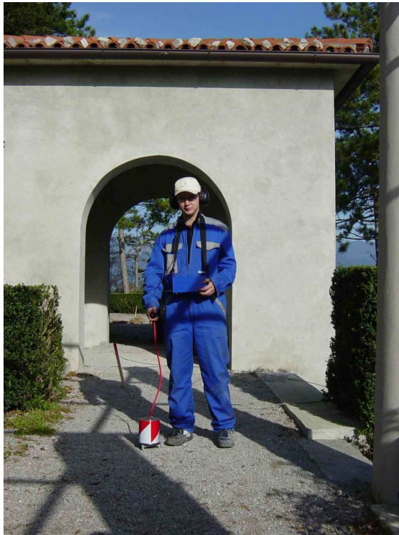
Slika 31: Iskanje puščanja ob severnem vhodnem stolpu v Ferrarijev vrt
