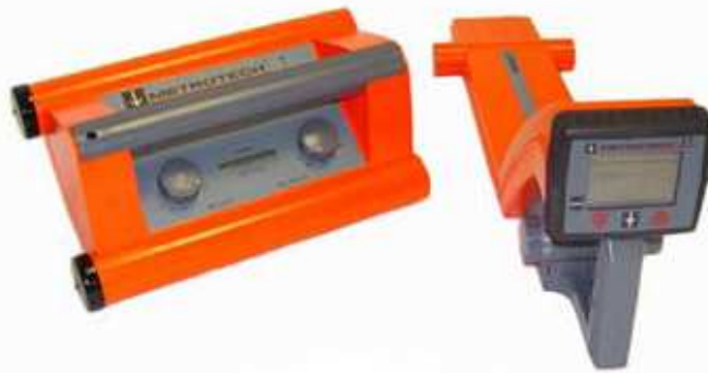
Slika 9: Iskalnik podzemnih napeljav (Metrotech Corporation, 2003)
