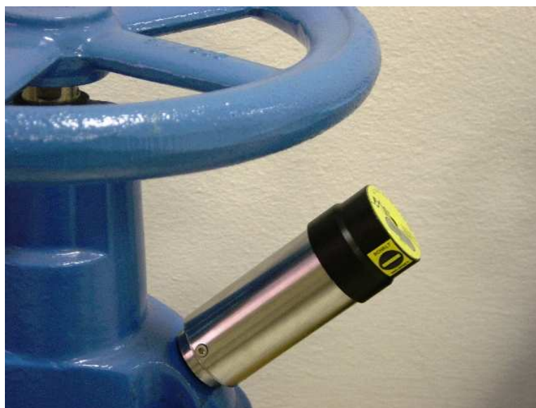
Slika 25: AZ radio zbiralnik šumov pritrjen na ventil in pripravljen na meritev
