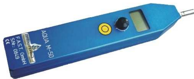
Slika 28: Elektronski merilnik šuma (Andotehna d.o.o., 2005)
