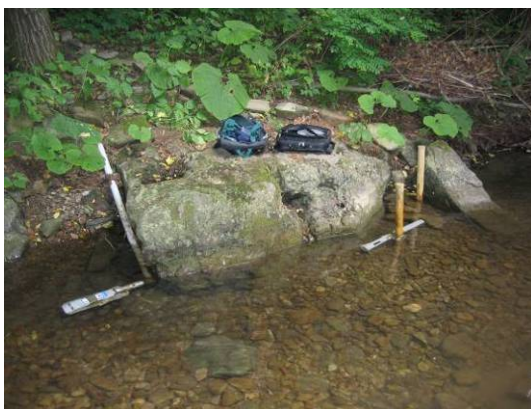
Slika 3.13c: Merilec višine vode (levo) in multiparametrška sonda (desno) v profilu vodomerne postaje Padež03 (foto: S. Rusjan, 6. 6. 2006).
