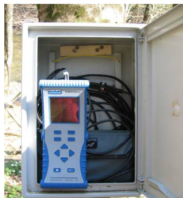
Slika 3.13d: Spominski modul multiparametrške sonde z baterijo (foto: S. Rusjan, 14. 4. 2006).
