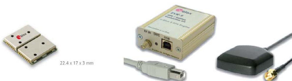
Slika 2-2: Modul GPS (levo) in preizkusni set (desno) – vir: spletna stran u-blox
