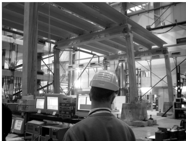
Slika 2.17: Deformirana konstrukcija pri povprečnem zasuku 8 % (Prototip 2-2) Figure 2.17: The deformed structure at 8 % drift (Prototype 2-2)
