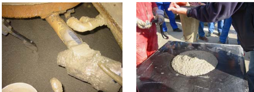
Slika 3.16: Betonski mešalec v betonarni CGP Novo mesto (levo) in premajhen razlez s posedom (desno)
