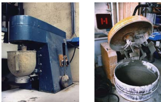
Slika 3.8: Standardni mešalec za malte in paste (levo) in protitočni mešalec za betone (desno)
