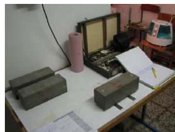
Slika 5.42: Huggenbergerjev deformeter z natančnostjo 0,0001 inče (levo) in meritve vzdolžnih deformacij betonskih prizem (desno)
