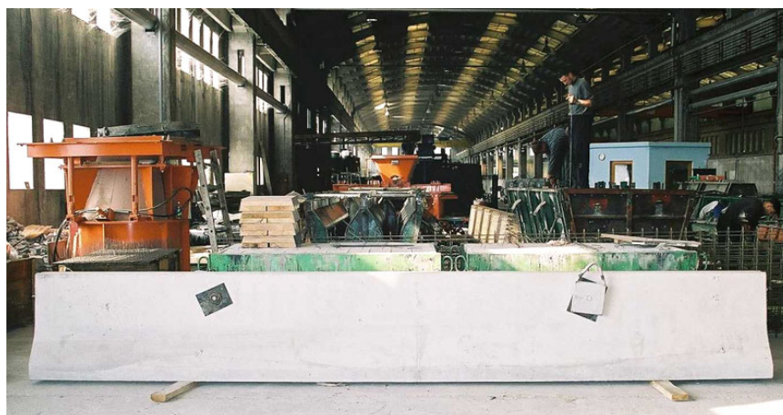
Slika 3.19: Izdelan AB element »New Jersey« v obratu GOBI podjetja Primorje d.d. iz Ajdovščine Fig. 3.19: Finished full scale SCC element at concrete plant GOBI-Primorje from Ajdovščina
