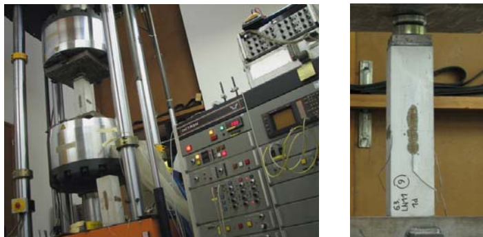
Slika 4.19: Preizkuševalni stroj z računalniško krmiljenim obremenjevanjem (levo) in preizkušane (desno)
