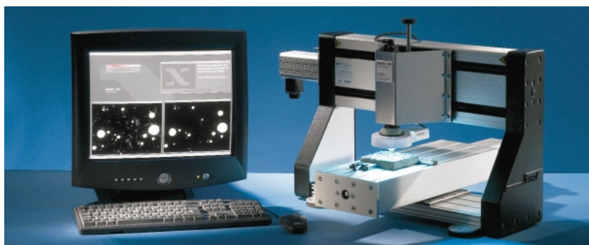
Slika 6.15: RapidAir 457 – analizator zračnih por (RapidAir, 2006)
