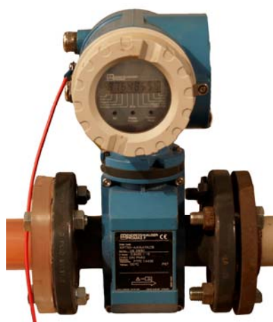
Slika 5.17: Induktivni merilec pretoka Endress & Hauser Promag 30F
