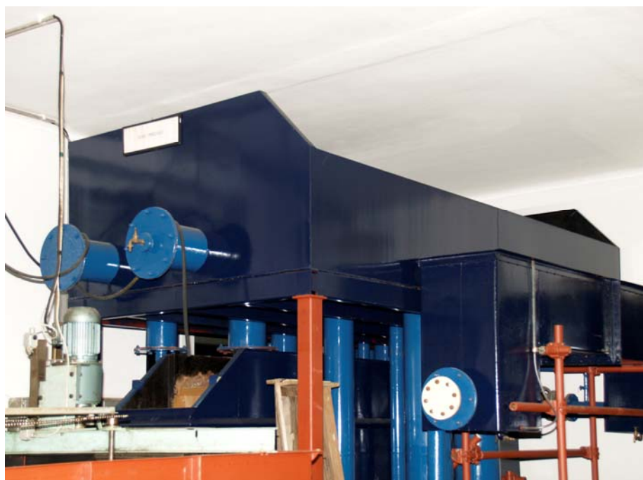
Slika 5.3: Umirjevalni bazen s prelivom
