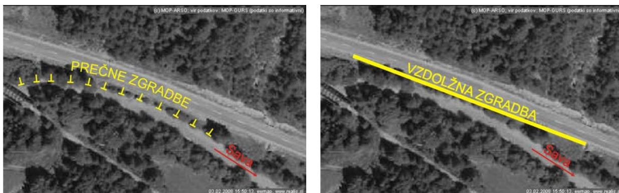
Slika 3.3: Situacija prečnih zgradb oziroma vzdolžne zgradbe
