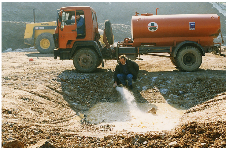
Slika 5.22 Preprosti preiskus, ki je služil za grobo oceno ustreznosti ali neustreznosti prepustnosti vgrajenega materiala v drenažne preproge
