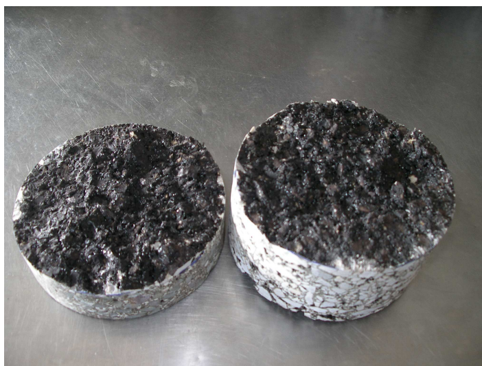
Slika 11: Primer ločene asfaltne izvrtine za nadaljnje preiskave na BB in BD (po poružitvi)
