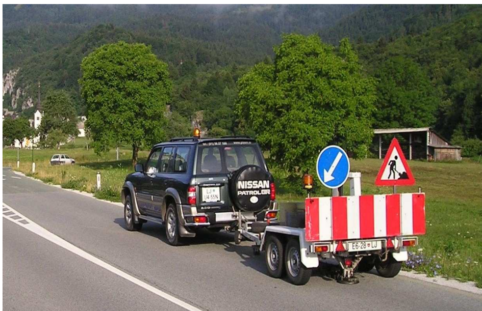
Slika 3: Merilna oprema FWD, Deflektometer s padajočo utežjo
