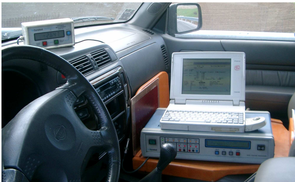
Slika 5: Sprotno izpisovanje izmerjenih vrednosti podajnosti (defleksij) na terenu
