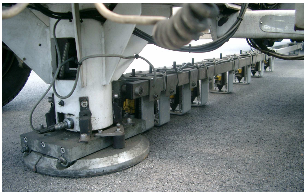
Slika 4: Primer izvajanja meritev nosilnosti z obremenitvijo na krožno ploščo z merilno opremo FWD
