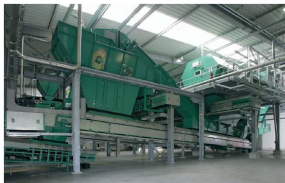
Slika: Sprejem odpadkov (Rettenberger, 2007) Slika: Balistični separator (levo) in bobnasto sito (desno) (Merten in sod., 2006)
