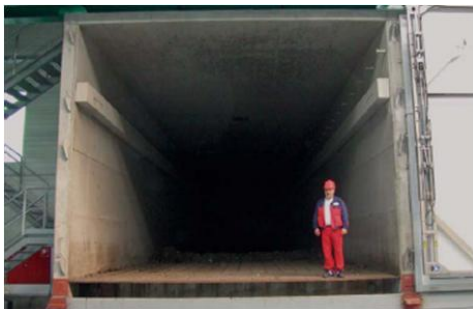
Slika: Tunnel za bio-sušenje (Merten in sod., 2006)
