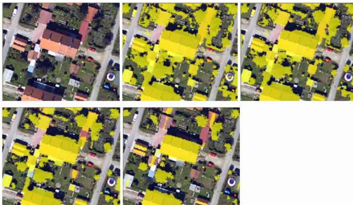
Slika 43: Na podlagi BDOF1 prikazani objekti, višji od 0.5 m, 1 m, 2 m, 3 m (od leve proti desni). Fig. 43: Objects, higher than 0.5 m, 1 m, 2 m, 3 m (from left to right), shown on DOF.
