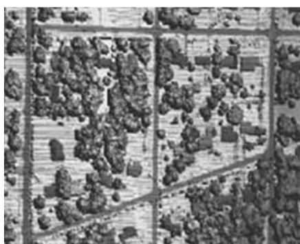
Slika 26: Šum na podobi intenzitete (Nobrega, 2005). Fig. 26: Noise on intensity image (Nobrega, 2005).
