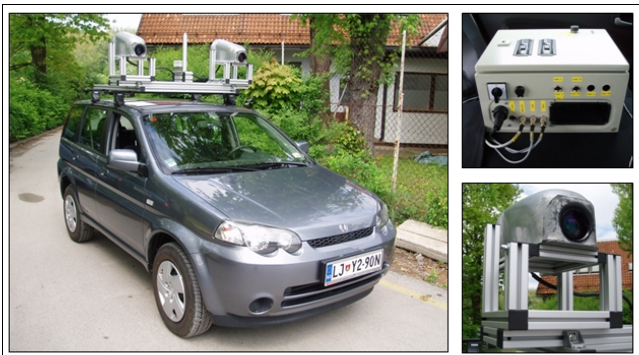
Slika 2.2: Mobilni kartirni sistem WideoCar druge generacije
