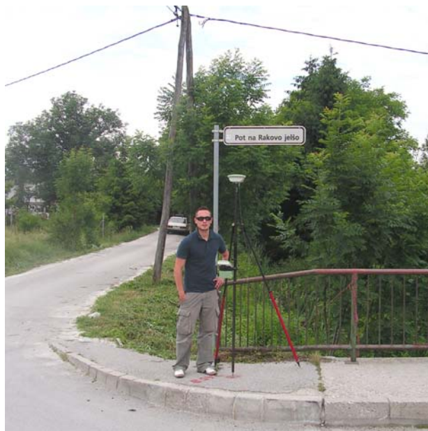
Slika 46: Izmera točk geodetske mreže z Leica SmartRoverjem
