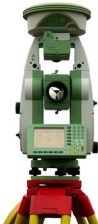
Slika 45: Tahimeter TCRM1201 R300 z GNSS sprejemnikom ATX1230
