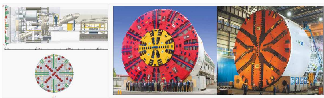
Slika 3: Stroji za rezanje celotnega profila predora (TBM). Levo TBM uporabljen za vrtnanje železniškega predora za Canada Line v Vancouveru, na sredini španski TBM \phi 15,2 in desno kitajski TBM \phi 15,43 m (vir: Eisenstein 2007; Thewes, 2007)
