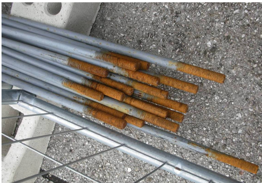
Slika 7.5: Demontirane potresne jeklene vezi, kjer je vidna močna prisotnost korozije na navojnih delih palic, ki so bile v stiku z napenjalci iz druge kovine (galvanski člen), korozijski produkti pa so v manjšem obsegu vidni tudi po ostalih površinah vezi
