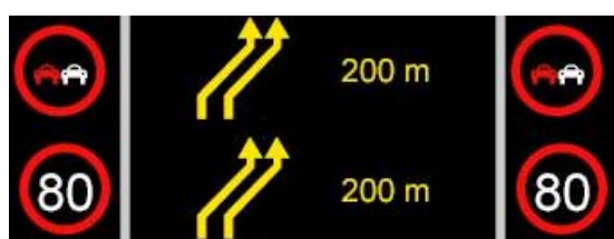
Slika 4-12: Prometna vsebina na SPIS 03L - območje »šikane« Figure 4-12: Variable Message Sign content on VMS 03L
