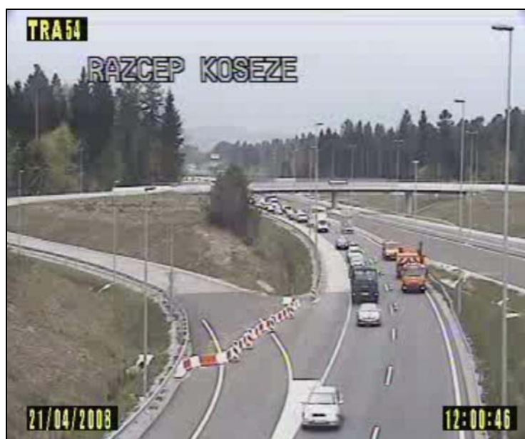
Slika 4-26: Neenakomerno pospeševanje (speljevanje) z območja zapore
