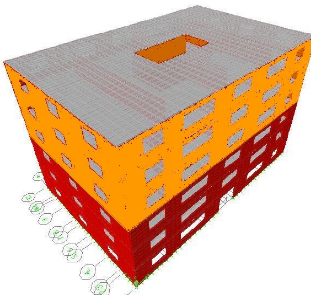
Slika 28: Osnovna konstrukcija z lesnim KLH nadzidkom
