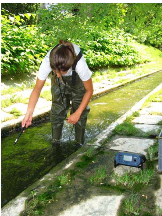
Slika 3.3: Merjenje koncentracije raztopljenega kisika in nasičenosti vode s kisikom (foto: Peter Simončič)
