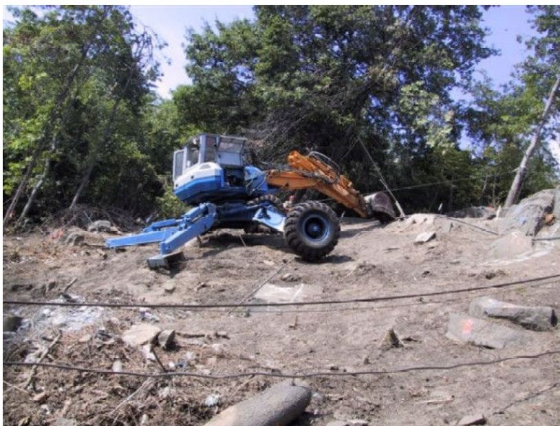
Fotografija 9: Poseben stroj imenovan »Pajek« za odstranjevanje skal (Vertec, 2006).
