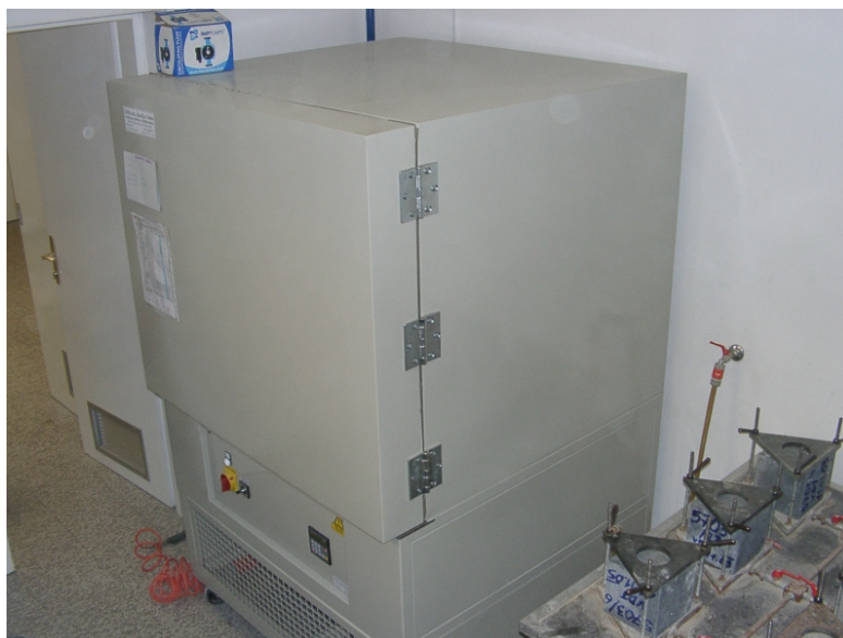
Slika 21: Komora za določitev adiabatnih termičnih karakteristik betona.
