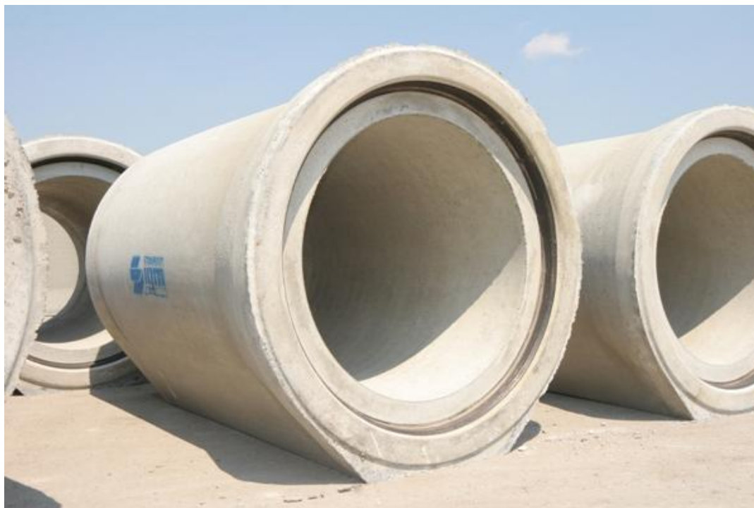
Slika 41: Armiranobetonska cev z ravnim dnom in vgrajenim gumijastim tesnilom
