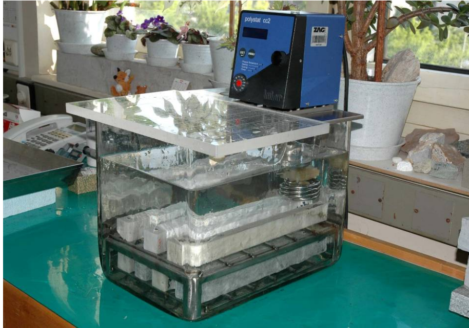
Slika 22: Toplotna kopel za ogrevanje vzorcev med določanjem toplotno-hidrične ekspanzije
