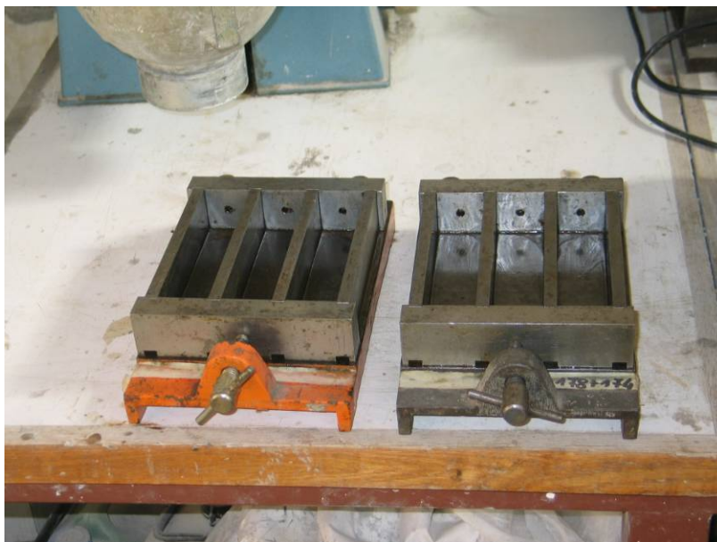
Slika 21: Standardni tridelni kalup za izdelavo prizmic 4*4*16 cm 3
