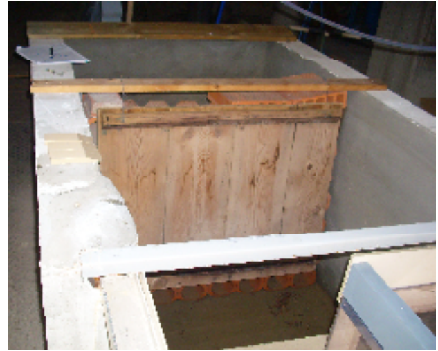
Slika 20: Zbirna posoda za umiritev pulzacij in lesen plošč za zagotovitev nevalovitega natoka na območje modela
