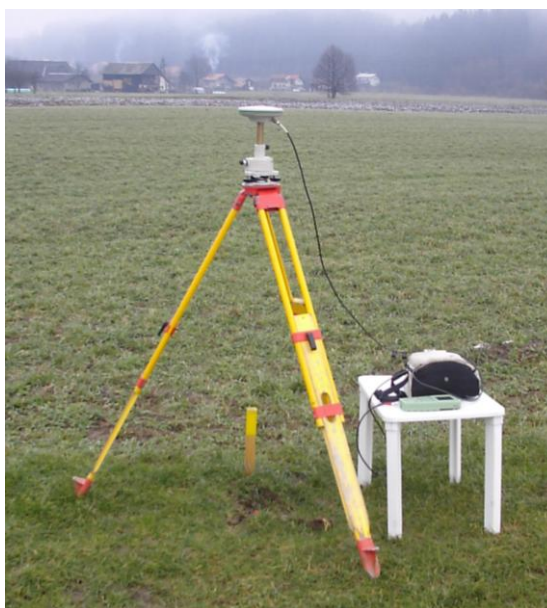
Slika 8: Postavitev instrumenta pri statični metodi izmere GPS
