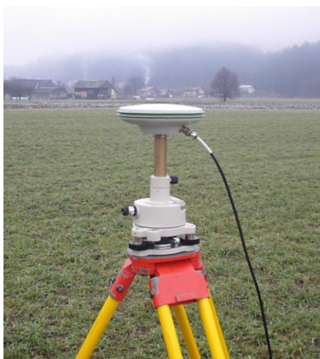
Slika 7: Namestitev antene pri statični metodi izmere GPS
