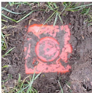
Slika 4: Stabilizacija točk s plastificiranimi betonskimi glavami in s kovinskim sidrom
