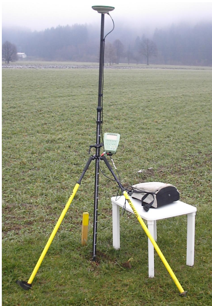
Slika 10: Postavitev instrumenta pri izmeri GPS z VRS metodo
