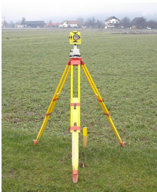
Slika 12: Signaliziranje točk pri klasični terestrični izmeri
