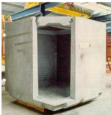
Slika 24: Armiranobetonski zabojnik za skladiščenje radioaktivnih odpadkov.
