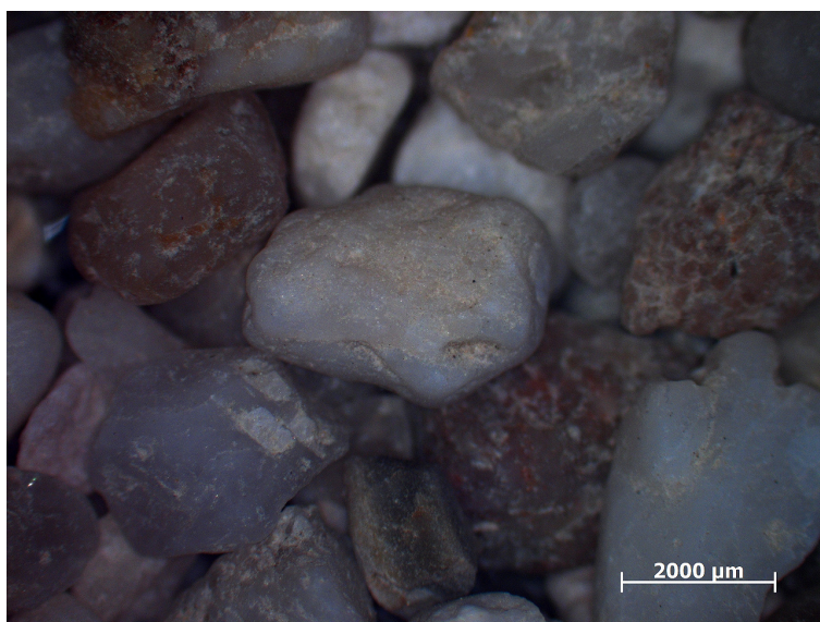
Slika 5.2: Mikroskopska slika zrn enozrnatega peska
