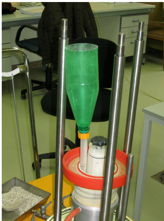
Slika 4.4: Sestavljanje peščenega votlega vzorca po metodi suhega nasipavanja
