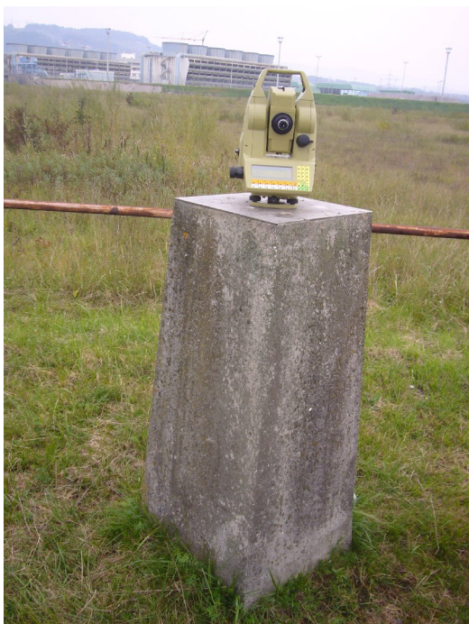
Slika 2: Betonski steber: stabilizacija referenčne točke O5
