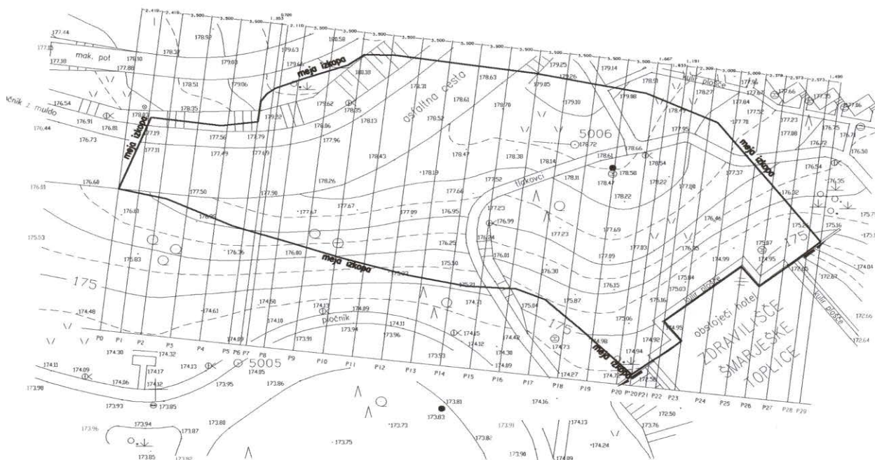
STANJE TERENA PRED IZKOPOM S SITUACIJO PREČNIH PROFILOV
