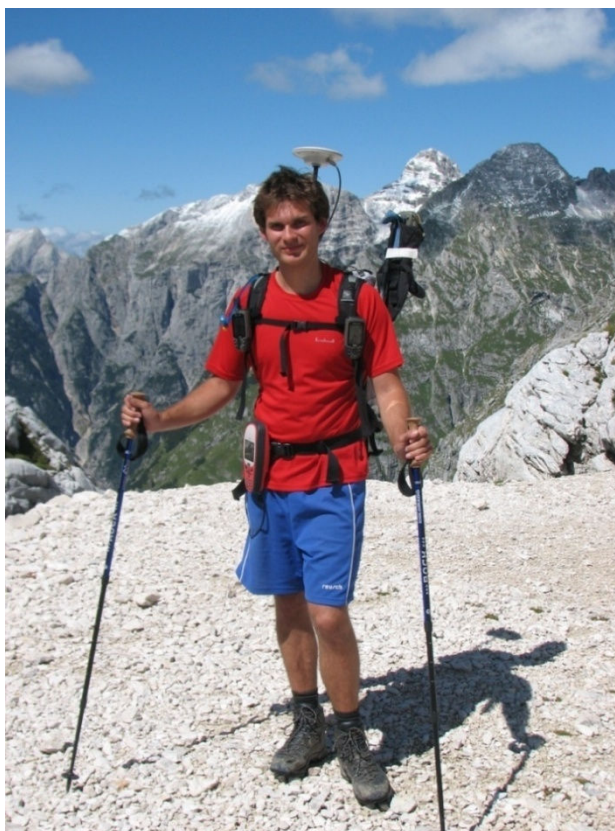
Slika 7: Namestitev merske opreme na pohodnika med opravljanjem terenskih meritev
