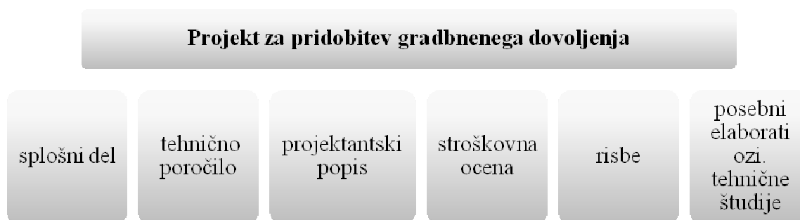
Slika 19: Sestavine projekta za pridobitev gradbenega dovoljenja
