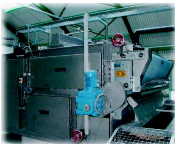
Slika: Slika in shema primera tračne preše Huber Bogenpress BS (Vir: Proizvajalec)
