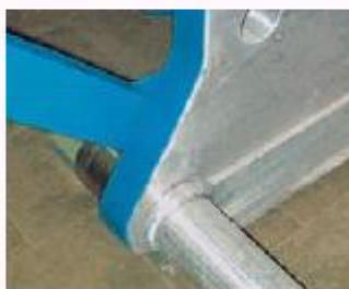
Edelstahlverkleidung für den Nahrungsmittelbereich, z.B. für Biermaische
