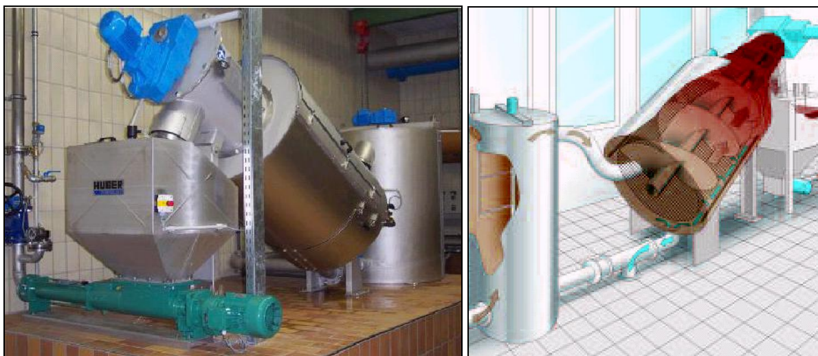
Slika: Primer in shema delovanja zgoščevalnika Huber Rotamat RoS 2; (Vir: Proizvajalec)
