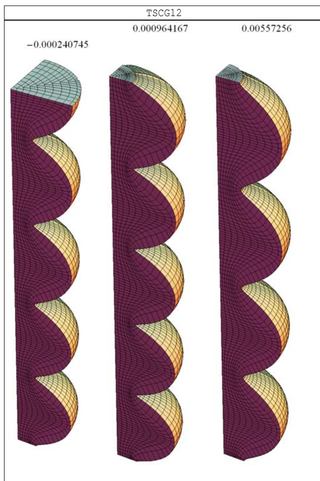
Preglednica 8: Stabilnost končnih elementov pri testu s palico: Kritični pomik w_{kr} [mm] in število valov pri končni deformirani legi glede na število prostostnih stopenj
