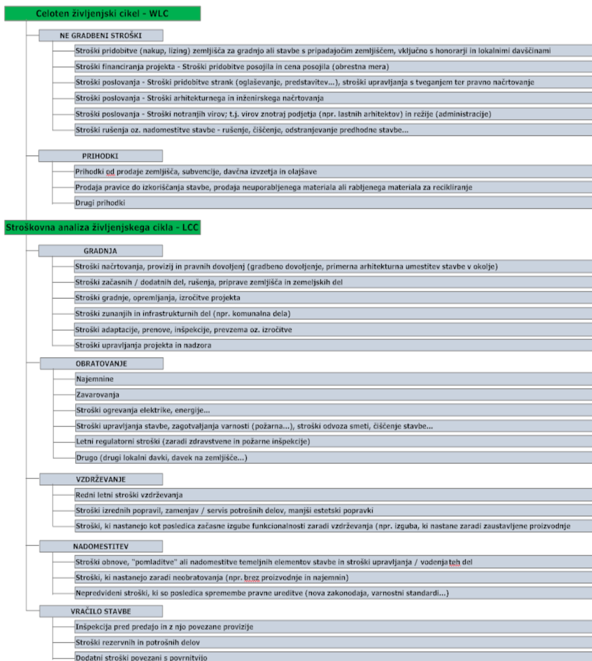
Slika 2: Tipičen obseg stroškov v celotnem življenjskem ciklu objekta in prikaz stroškov, ki jih lahko obravnavamo pri LCC analizi
