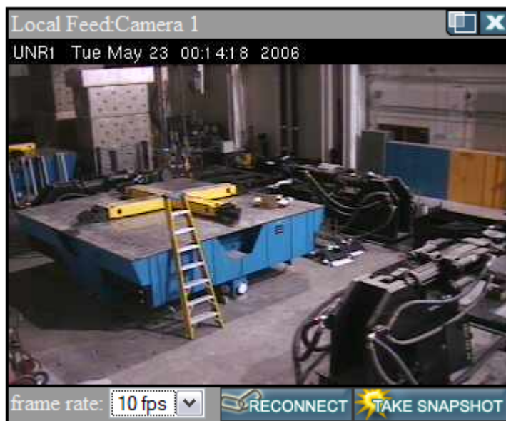
Slika 3: S pomočjo kamer lahko potek preizkusov spremljamo v realnem času. Na sliki je prikazana ena izmed potresnih miz v laboratoriju na univerzi v Nevadi -Reno
