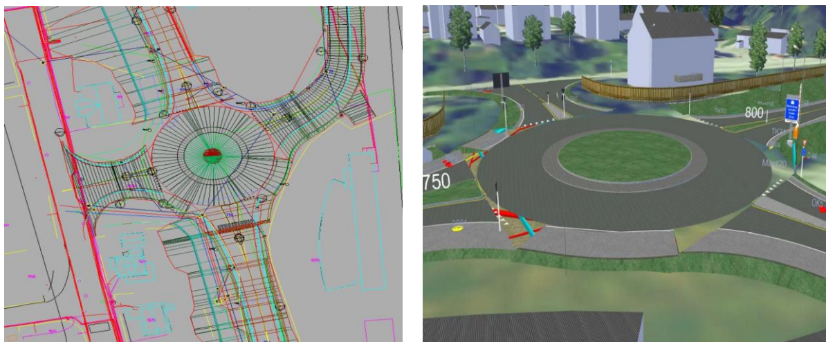
Privzeta slika 6: Klasičen 2D pogled krožišča v situaciji na sliki levo ter krožišče v 3D pogledu na sliki desno (Haugbotn, A. 2009).
