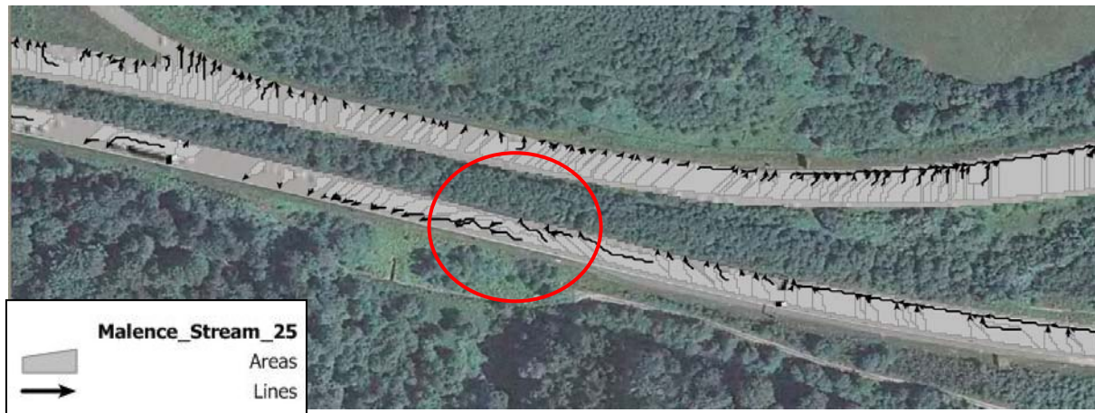
Slika 54: Prikaz prevojnih točk na AC, določenih z VRDMR, na območju odvodnje kot pomembne informacije za odvodnjo s cest, prikazane na ortofoto podlagi
