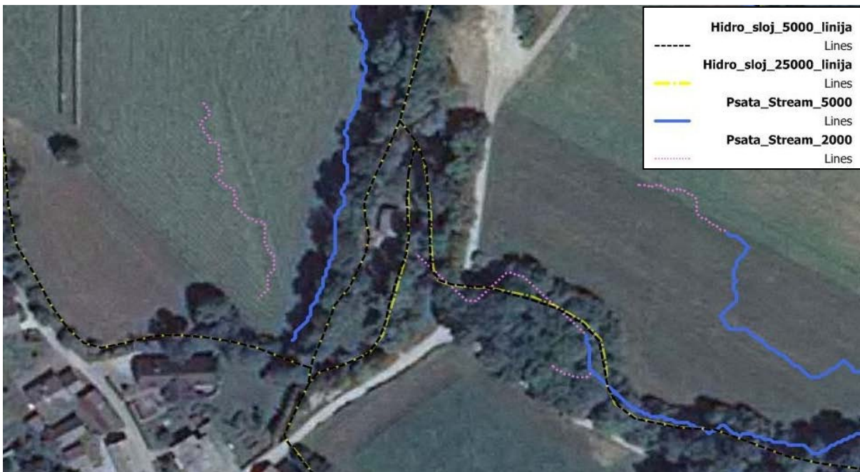
Slika 45: Prikaz hidrografske mreže, določene z VRDMR, skupaj s hidro slojem iz DTK 5 in GKB 25 v okolici objekta na ortofoto podlagi
