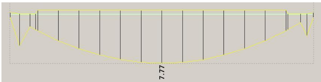
Slika 62: Potrebna količina armature A_s ( cm^2 )
