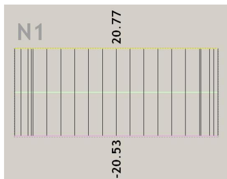
Slika 58: Ovojnica projektnih osnih (N1) sil v rebrasti plošči
