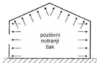
Slika 25: Delovanje pozitivnega notranjega tlaka (pritiska)
