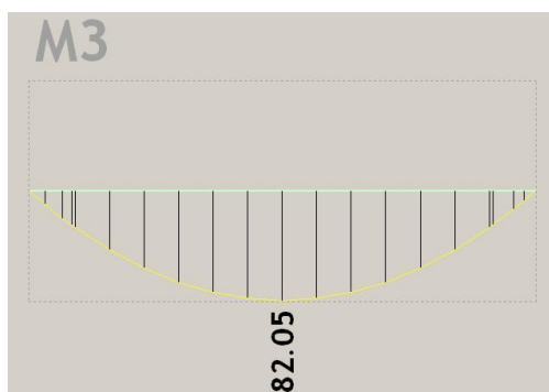
Slika 60: Ovojnica projektnih upogibnih momentov ( M_3 ) v rebrasti plošči
